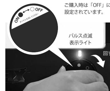
Sシリーズには、バッテリー残量が減りすぎるのを防ぐために、「バッテリーセーブ機能」が搭載されています。そのため、「パルス間隔の長さ」と「パルス点滅表示ライトの色」によって、おおまかにバッテリーの状況を把握することができます。
